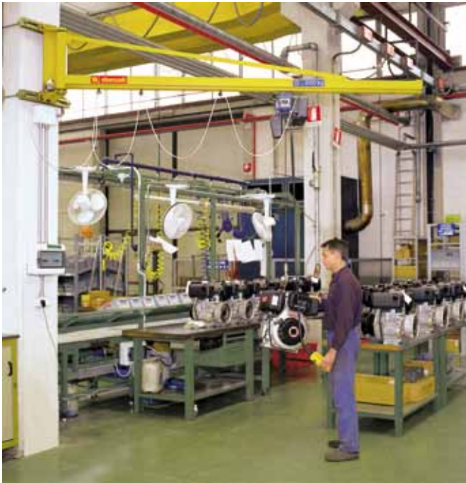
Vægmonteret svingarm for lavere egenvægt, typ LRV med C-profil, manuel talje.
