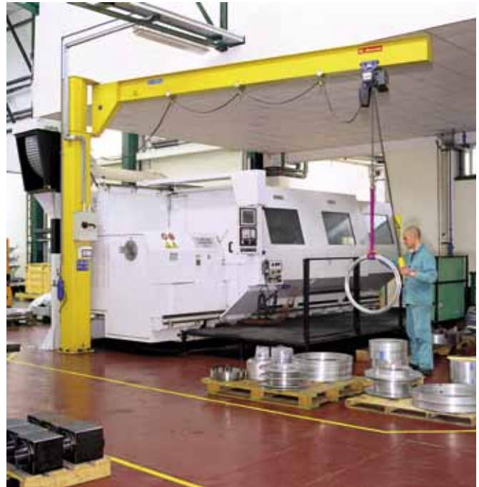
Gulvmonteret søjlesvingarm for lavere byggehøjde, typ IPU med I-profil, manuel talje.
